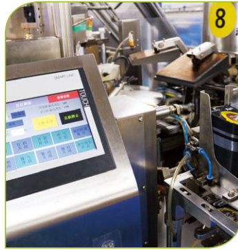
引進真空包裝機：真空鴨頭、雞蛋由人工裝袋切換為顆粒機裝袋，包裝效率提升了500%
