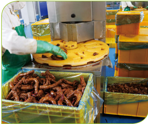
新型的鴨脖機：真空鴨脖砍切引進自動分離鴨脖頭的砍切設備，省去了分離鴨脖頭的環節，提高生產效率
