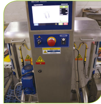
基礎X光機改進：真空外包由小袋過X光機切換為直接在封口後裝箱前流水綫式過金探，省去小袋產品過X光機的環節
